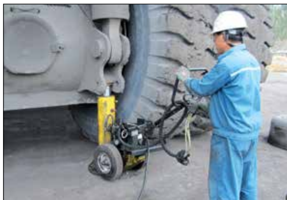
◀ POW'R-RISER® de Enerpac usado em operações de mineração para levantar equipamento pesado.
