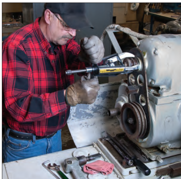
◀ Posicionando um Extrator EP-104, com 3 garras na polia de acionamento de um motor elétrico.
